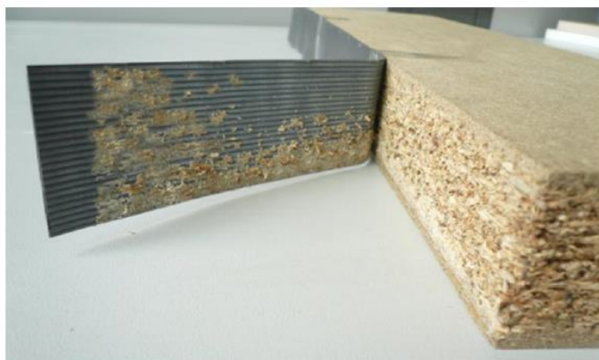
Figura 65. Esempio di incollaggio con rullo applicatore non in squadro
