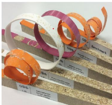
Figura 44. Bordi dopo la prova di peeling a 90°
