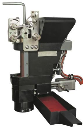
Figura 34. Rullo spalmatore alimentato dall'alto
