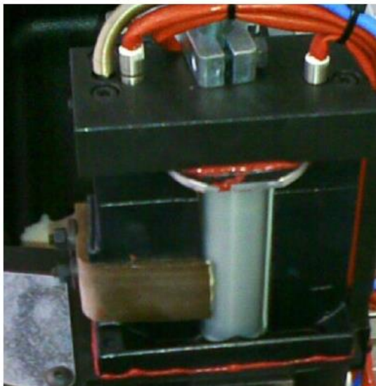
Figura 62. Rullo applicatore correttamente alimentato
