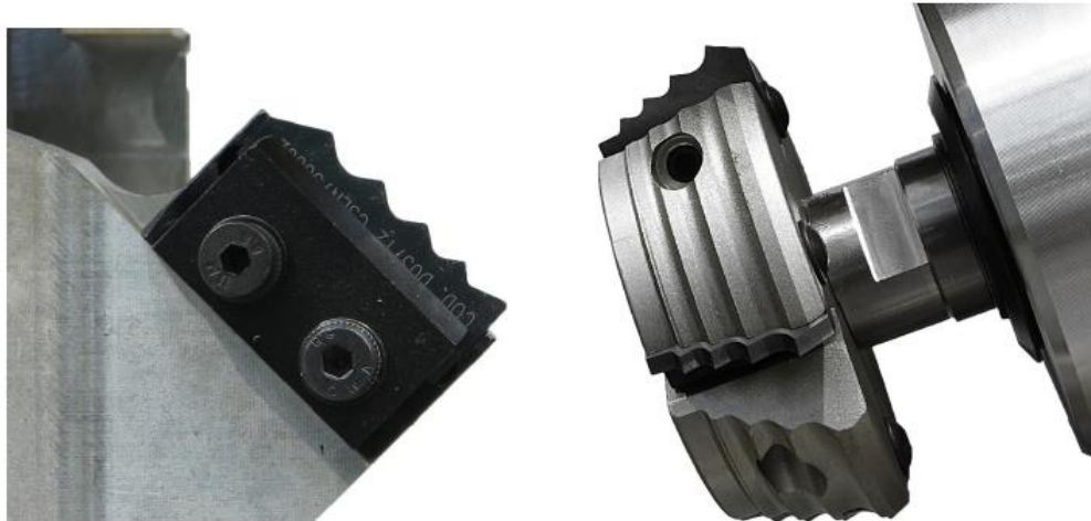
Figure 79. Esempio di utensili correttamente affilati
