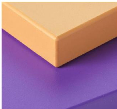
Figure 80. Esempio di bordo perfettamente lavorato senza "battute"
