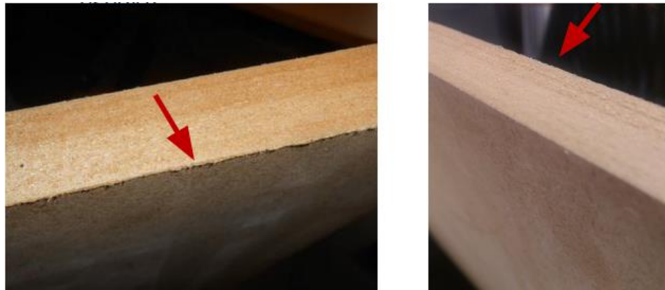
Figura 73. Esempio di pannello con linea di taglio rovinata da utensile usurato
