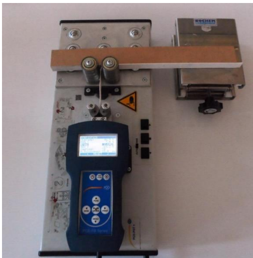
Figura 39. Dinamometro portatile per la determinazione della forza di peeling sul bordo
