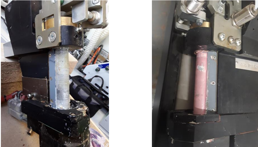
Figura 68. Esempi di testine con adesivo poliuretano reticolato
