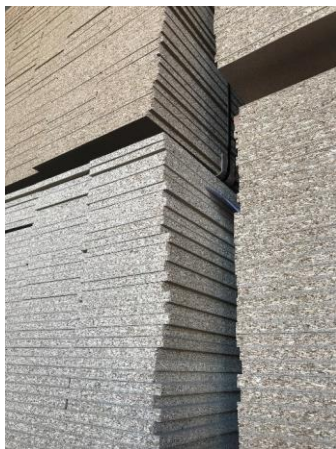
Figura 5. Pannelli di particelle (truciolari)
