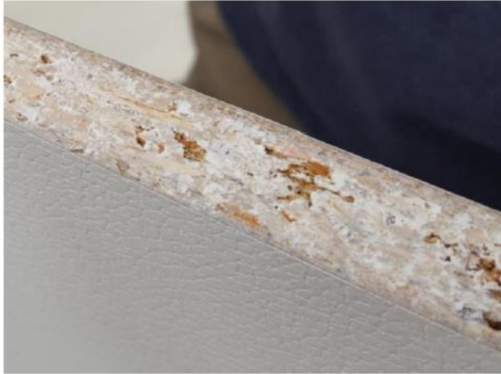
Figura 71. Esempio di strato funzionale delaminato
