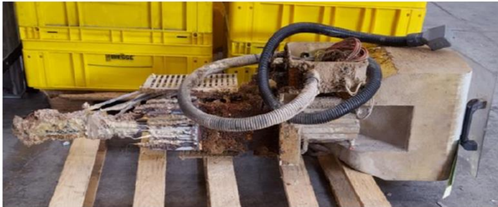
Figura 49. Esempio di prefusore non pulito
