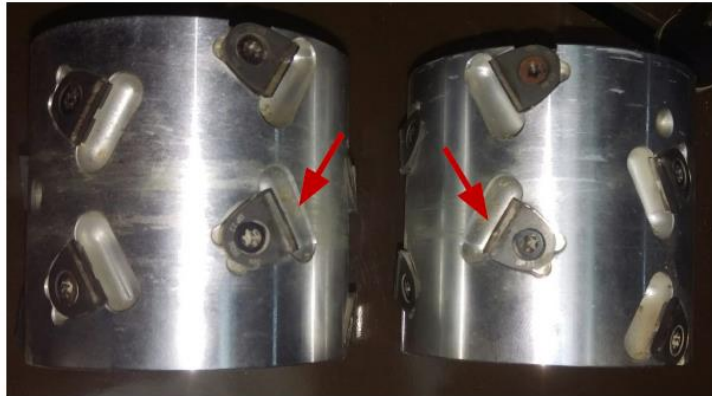
Figura 72. Esempio di utensili della rettifica usurati
